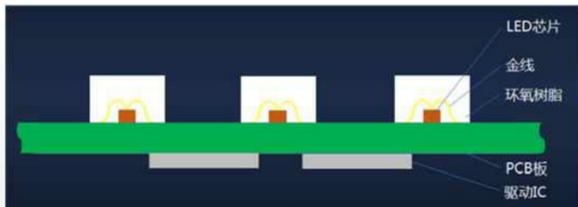
图 4 COB 封装芯片示意图
