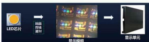
图 5 COB 封装流程图
