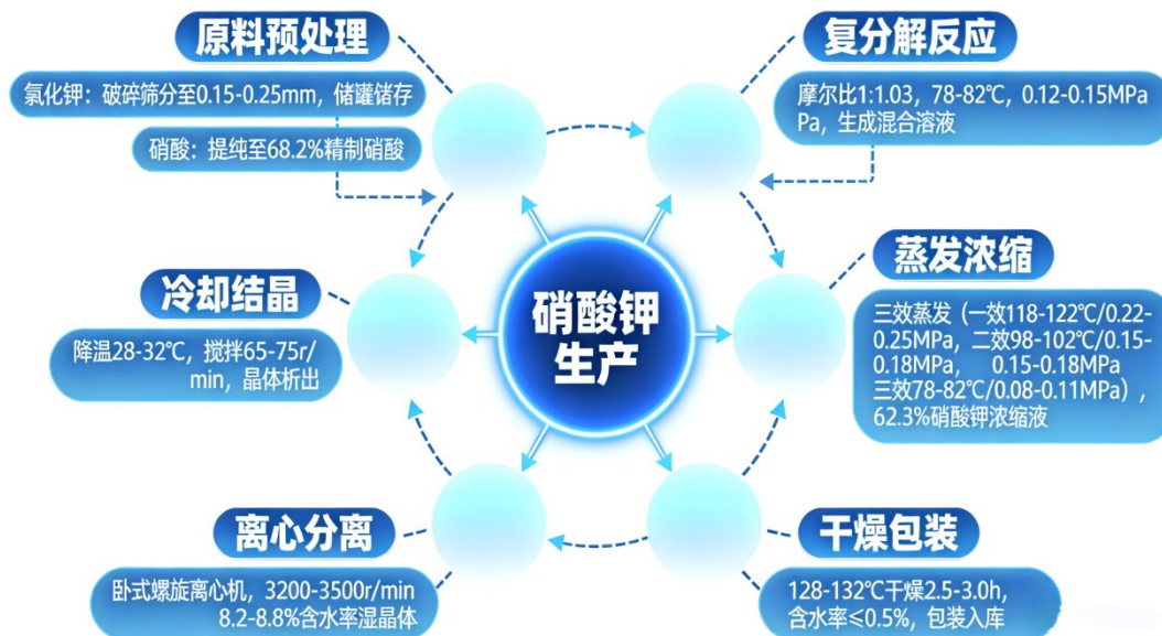
图 1 各单元生产工艺图
