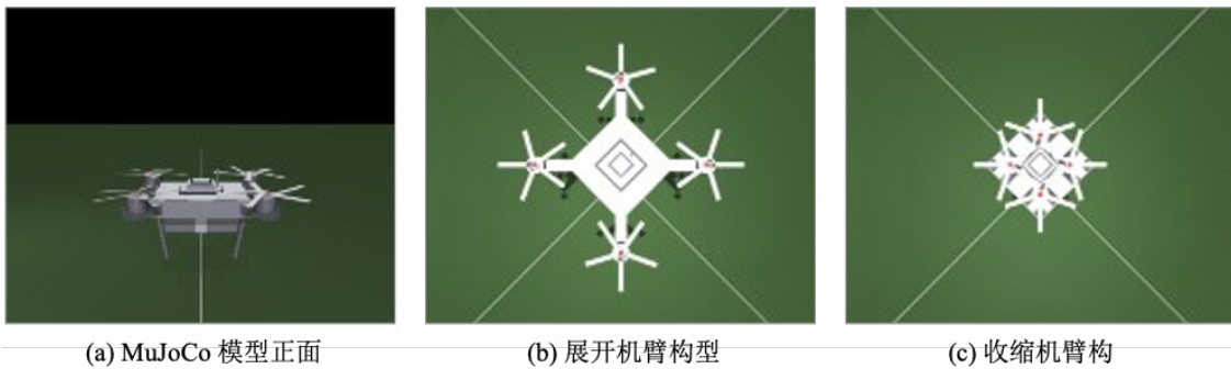
图 9 MuJoCo 可变形四旋翼模型与典型臂长构型
