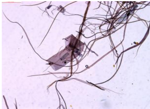
图 5C 《楚辞集注》补纸纤维形态
