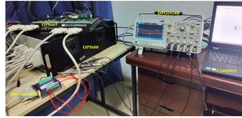
图 3 硬件在环平台的照片与实验搭建
