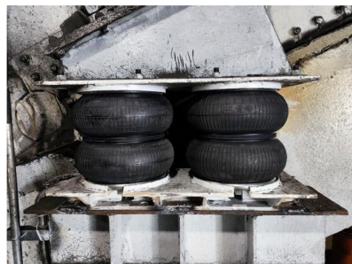
(b) 改造后:多层膜片式空气弹簧
