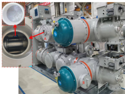
图7 GIS 内置局放传感器灵敏度有效性测试
