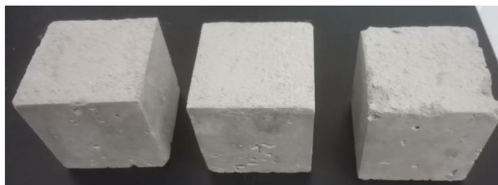
图 1 容重及抗压强度测试样块图
