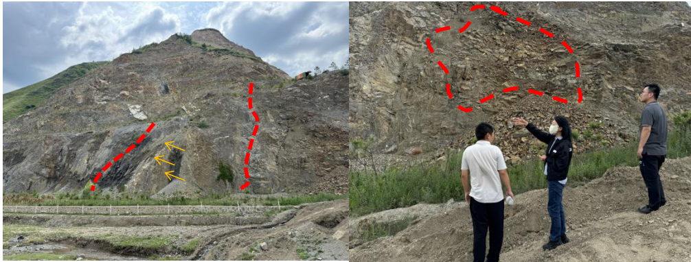
图 4 F 1 逆断层、擦痕、局部破碎带示意图
